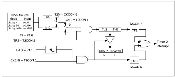
Figure 14. 16-Bit Capture Mode
