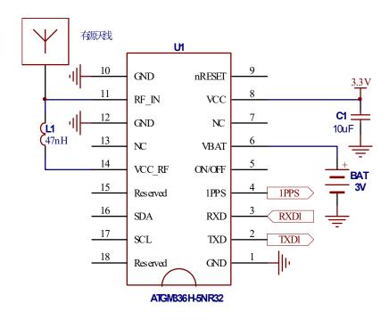
2.7.2 无源天线应用方案(模块 RF\_IN 输入端增加一级 LNA)
